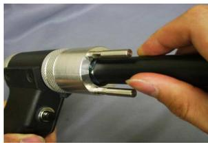
5-最後に加圧ゲージを使いガンシャフトからボルト溶接面が加圧ゲージ上面と水平になるようガンリングを回して調整します。最後にロックリングを締め付けロックし完了です。
