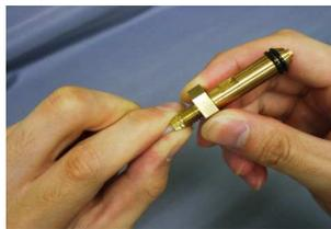
4-ガンシャフトにねじ込み、レンチを使ってしっかりと締付けます。
