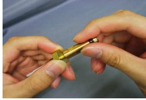
2-付属品の工具を使いしっかりと締付けます。
