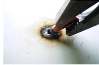
プライヤーやペンチなどでスタッドボルトの根元までつかみ左右に傾けて母材ごと取れるもしくはボルトの根元が折れるまで10回ほど繰り返します。
