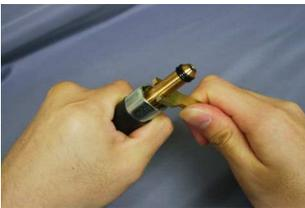
3-使用するスタッドボルトをチャックに差し込み、ストッパーでボルトの出シロを約2mmにします。そして、ストッパーに付いているリングで動かないようロックします。
